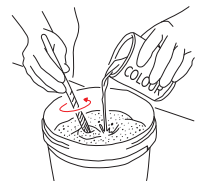
将色浆加入石灰基并搅拌均匀
